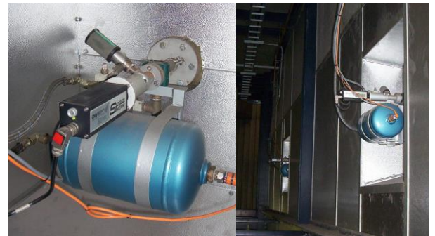
Pyrometer mit Luftk6hlmantel und Shock-Blower
