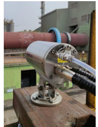
Infrarot-Kamera im Protectiongehäuse mit Blick auf den Drehrohrföfen
