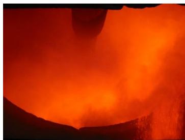
CCTV-Bild: Durchsicht durch den Ofen sehr gering aufgrund hoher Staubbeladung.
