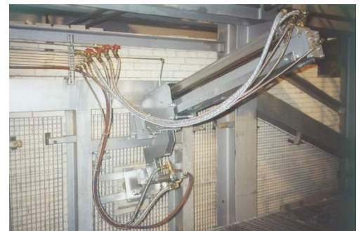
Infrarotkamera PYROINC 768N mit Luftspülung, Wasserkühlung und Notrückzugvorrichtung
