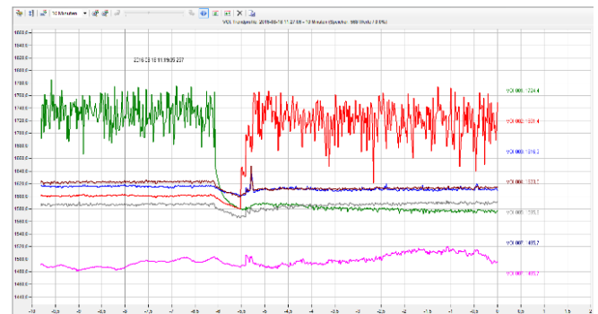
Temperaturverlauf über die Zeit. Gut zu erkennen der Brennerwechsel
